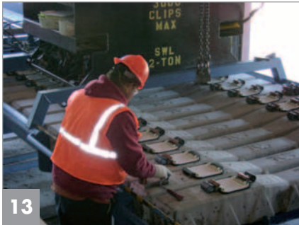
Der Schluss des Herstellungsprozesses: Beschneiden der Schwellen, Anbringung der Schienenbefestigungen, Transport und Lagerung.
