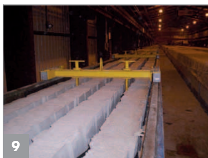
Ausschalen der erhärteten Betonschwellen
