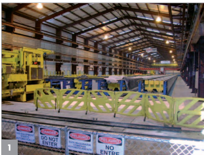
Auf jeder der vier Spannbahnen können 180 Betonschwellen hergestellt werden
