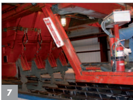
Betonhandling und Befüllen der Formen
